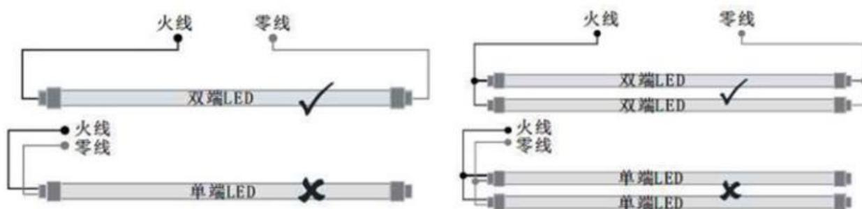
双端进电型号，只适合使用双端进电的灯管
