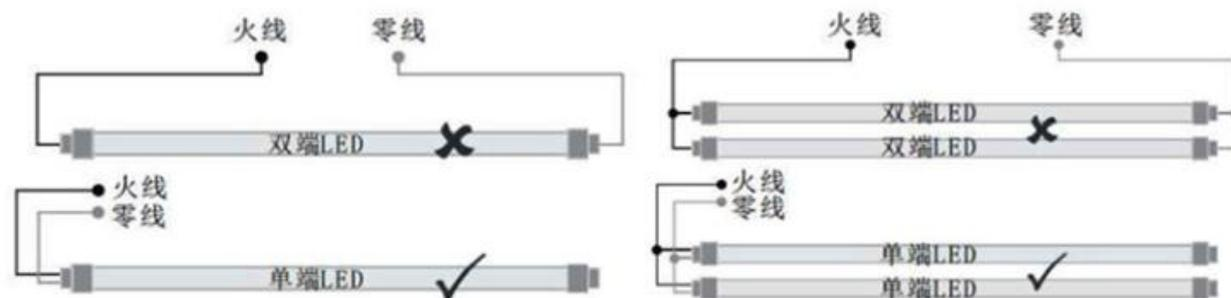
单端进电型号，只适合使用单端进电的灯管
